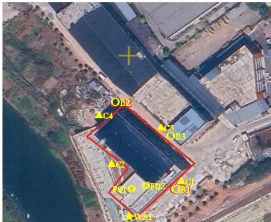
图例：★—废水监测点，○—有组织废气监测点，○—无组织废气监测点，▲—厂界噪声监测点
