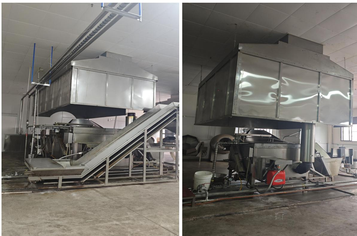
天然气燃烧废气、油炸工序油烟废气集气罩
