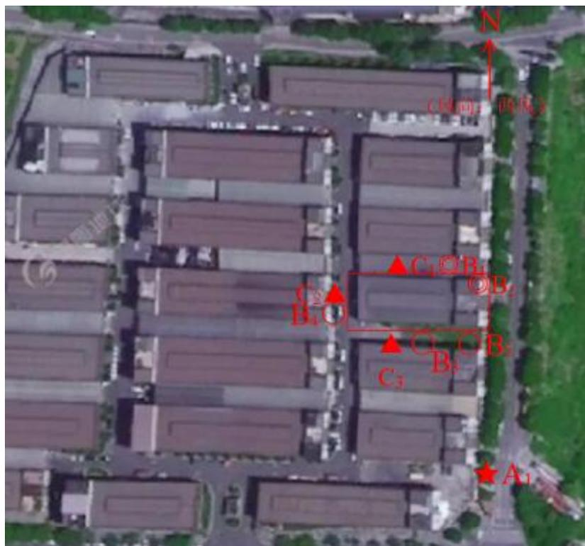
图例：★A 为废水监测点；◎B 为有组织废气监测点；○B 为无组织废气监测点；▲C 为噪声监测点。
