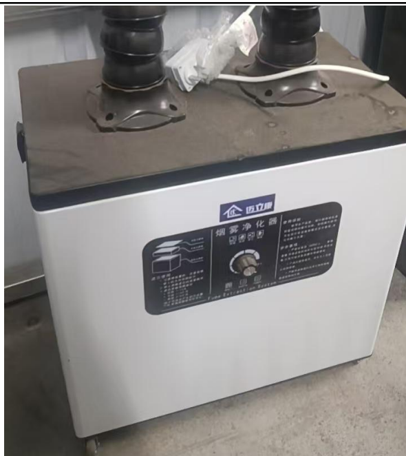
移动式焊烟净化器
