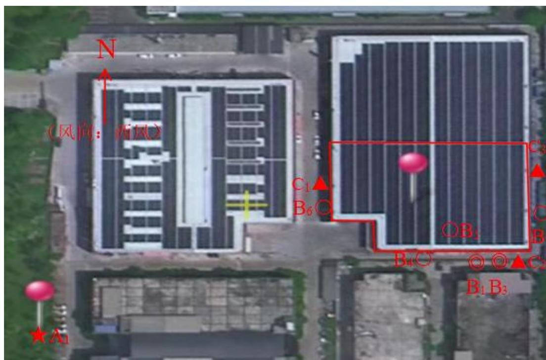
图例：★A 为废水检测点；◎B 为有组织废气检测点；○B 为无组织废气检测点。
